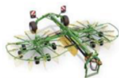
Двороторний валкувач з центральним укладанням валка Swadro TC
